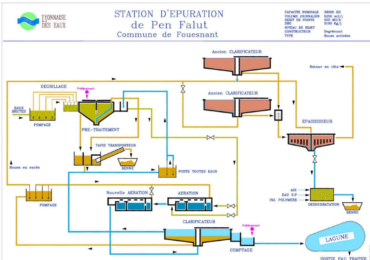
Figure 6 : Synoptique de la station d'épuration actuelle
